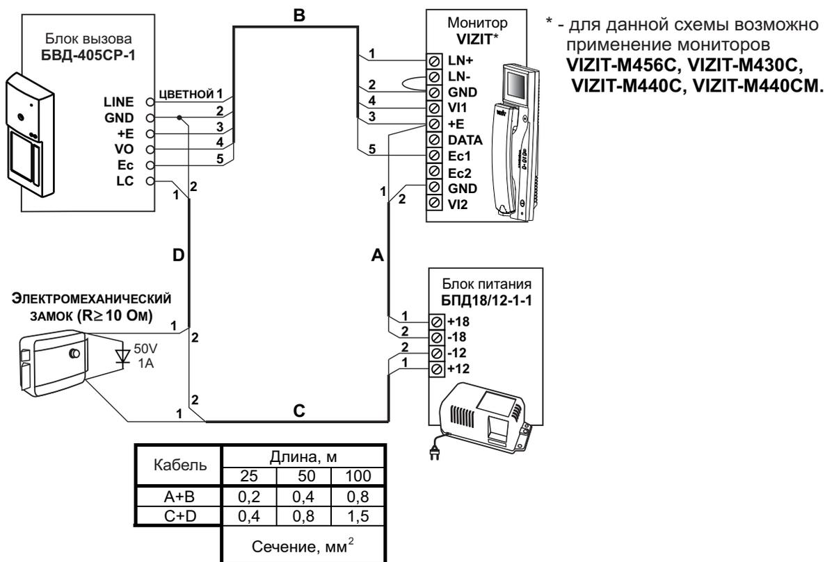
Рисунок 9 - Схема соединений БВД-405СР-1 с монитором, блоком питания БПД18/12-1-1 и электромеханическим замком
